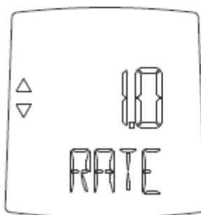
Geänderte Werte „UNIT“, „SHDWN“ und „RATE“ werden automatisch sofort gespeichert.
