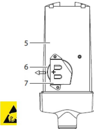
Sie sehen jetzt auf der Platine (5) die Batteriehalterung (7) mit der Batterie (6).
