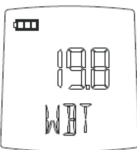
Feuchtkugeltemperatur angezeigt. Gleichzeitig erscheint im unteren Teil des Anzeigefeldes die Zeichenfolge „WBT“.
