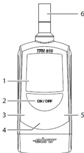
Mit dem Hygrometer TFH 610 bzw. TFH 620 können Sie gleichzeitig die relative Feuchte und die Temperatur messen.
