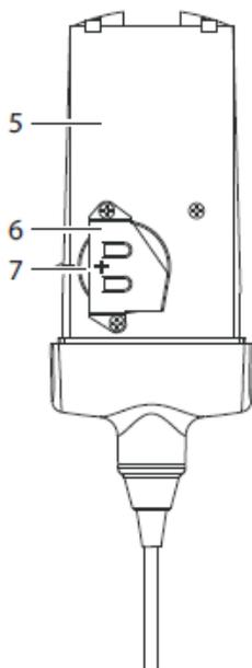
Sie sehen jetzt auf der Platine (5) die Batteriehalterung (7) mit der Batterie (6).
